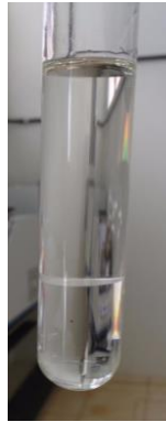
Figura 7 - Sistema Aquoso Bifásico (SAB) formado por polímero + sal + água
