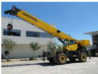
O transporte vertical tanto da estrutura como do telhamento serão feitos por meio de guindaste hidráulico autopropelido, com lança telescópica 41 m, capacidade máxima 43 T, potência 230 KW, ficam à cargo da *Contratada*.
