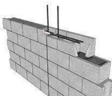
As alvenarias de fechamento dos espelhos das arquibancadas serão em alvenaria de vedação de blocos cerâmicos furados de 14x19x39cm (espessura 14 cm), inclusive argamassa de assentamento com preparo manual de cimento, cal e areia no traço 1:2:8.
